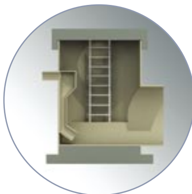
Šachta s vnitřním spadištěm
